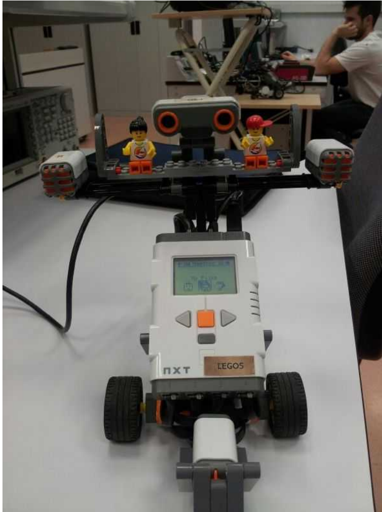
Fig. 4: Robot detector de sonidos con dos micrófonos
