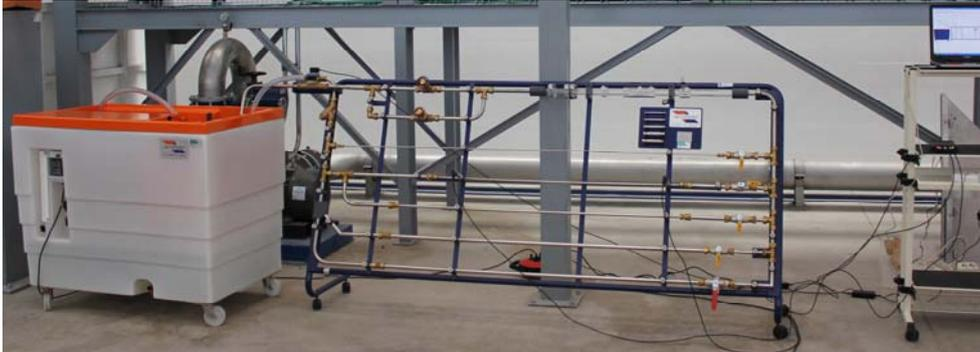
**Figura 6.** Sistema bomba (banco hidráulico)-red de distribución de agua
